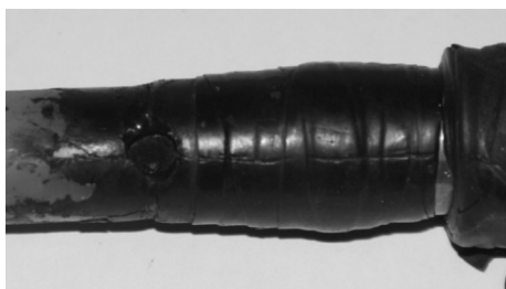
图3 环切2 mm刀痕缺陷击穿图
