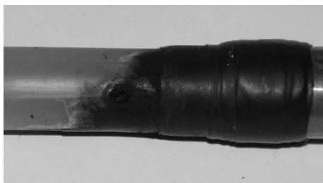
图8 纵切3 mm 刀痕缺陷击穿图
