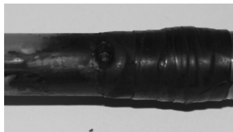
图5 环切3 mm刀痕缺陷击穿图
